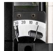
Optimierte Winkelskalen für einfaches Ablesen der Scheimpflug-Einstellungen.
